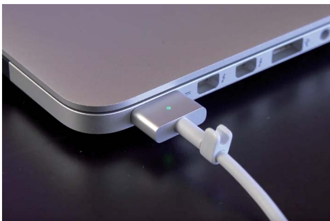
Obrázek 2: Indikace nabíjení umístěná na nabíjecím konektoru
