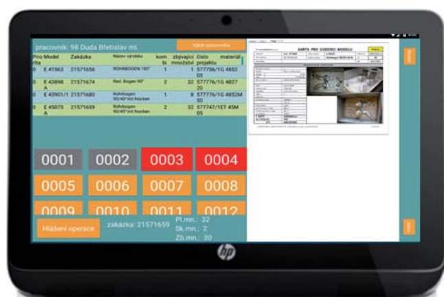
Na dalším pracovišti, kterým je formovna, se zakázka objeví až po provedení předchozí operace se zpožděním 24 hodiny (tuhnutí jádra) a po validaci modelu modelářem. Operace výroba jádra je již hlášena po jednotlivých výrobních číslech. Obsluze se také zobrazí zakázky napřed k trvalé filtraci pro nejbližší časové období a následně se pro vybranou zakázku zobrazí seznam výrobních čísel. Barevné rozlišení zvýrazňuje aktuální výrobní čísla k formování a poslední naformovaná výrobní čísla. Počet aktivních výrobních čísel pro formu je definován v TPV tzv. kombifaktorem. Obsluha má také trvale k dispozici zobrazení dokumentace k modelu i jádru. Odhlášením vznikne forma s jednoznačnou identifikací a pevně definovanými výrobními čísly. Současně je vytištěna etiketa viz Obrázek 6, která je fyzicky umístěna na formu. Etiketa dále poskytuje v dalším procesu informace o zakázce a materiálu, ze kterého má být odlitek vyroben.
